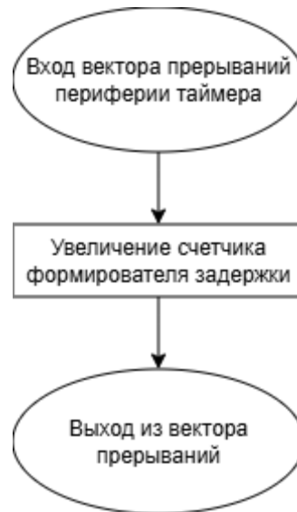
Рисунок 5 – Алгоритм обработчика прерываний периферии таймера
